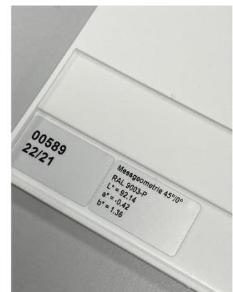
nous validons en cliquant sur **OK**. A noter : la distance entre l'extrémité frontale du capteur et la carte RAL 9003-P doit s'élever à 75mm.
